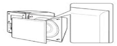
スピーカーグリルネットを取り換えるには 角を持って手前に引くと、元のネットを取りは ずせます。ふちに丸みのある側を上下にして、 新しいネットを取り付けてください。
