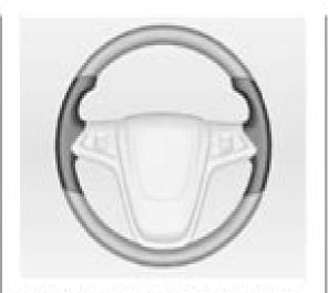
Le tradizionali zone di presa del volante vengono riscaldate più velocemente e a una temperatura maggiore rispetto alle altre zone del volante.
