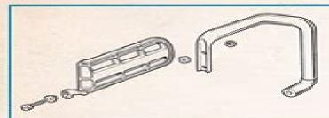
MONTAGGO PARAMANO MONTAGG OU PROTEGEMAIN HAND GUARD ASSEMBLY ANBAU DES HANDSCHUTZES MONTAGE DE PROTECCION
