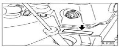
Die Motornummer und die Motorkennzeichnung sind auf der vorderen Motorseite in der Nähe des Ölmeßstabführungsrohres im Motorblock eingeschlagen.
