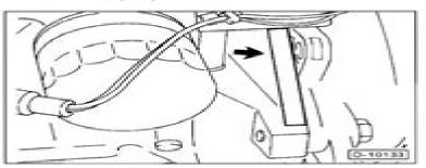
Die Motornummer und die Motorkennzeichnung befindet sich neben dem Ölfliter am Motorblock.
