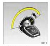
Antossen, Otto-Motor: Schaltgetriebe in Leerlauf und Kupplung getreten holten, Fußbremse betötigen, outomotisches Getriebe in Poder N. kein Gas geben, Schlüssel bis III drehen
