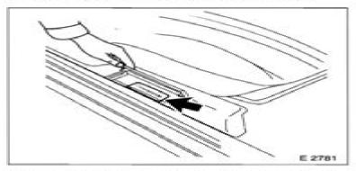
Die Fahrgestellnummer (Fahrzeug-Identifizierungsnummer) ist neben dem rechten Vordersitz in das Karosserie-Bodenblech eingeprägt sowie auf dem Typschild im Motorraum (am Träger oberhalb der Scheinwerfer). Auf dem Typschild steht die Fahrgestellnummer in der Regel an dritter Stelle, von oben gesehen.
